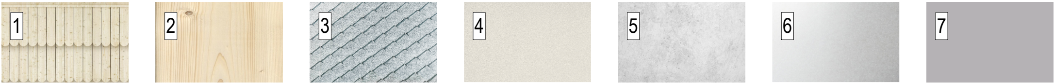
1 bardage bois naturel en planches bords à bords. mélèze 2 structure en épicea 3 toiture en losange 44x44cm en zinc (panachage grisé) 4 enduit gris chaud taloché fin 5 béton brut 6 métal galva/inox 7 RAL 9006
